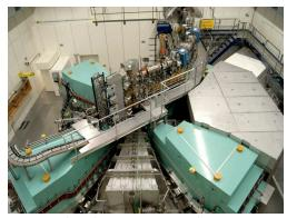
(b) 72 MeV Injector Cyclotron.
